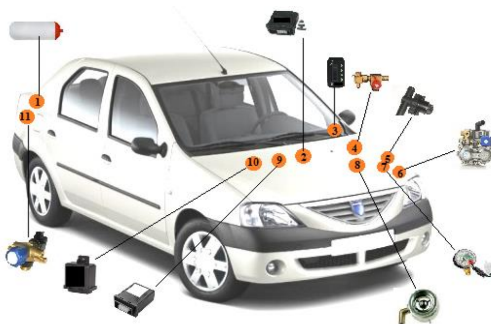
20. att. CNG/benzīna automobiļa uzbūves shēma
