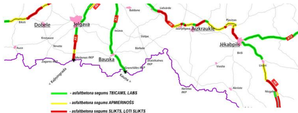
1.54.attēls. Valsts galveno autoceļu stāvoklis uz 14.02.2014.
