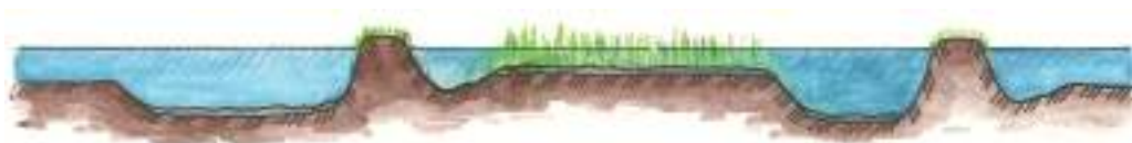
18. attēls. Virszemes plūsmas mitrāja šķērsriezuma shematisks attēlojums (Autors: Alise Trifane).
