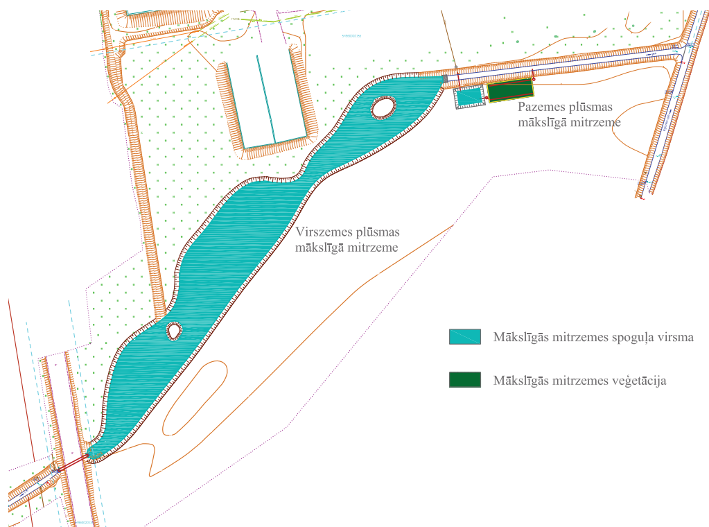
23. attēls. Virszemes un pazemes plūsmas mākslīgo mitrāju novietojums - z/s “Mežacīruļi” piemērs (Autors: Linda Grinberga).
