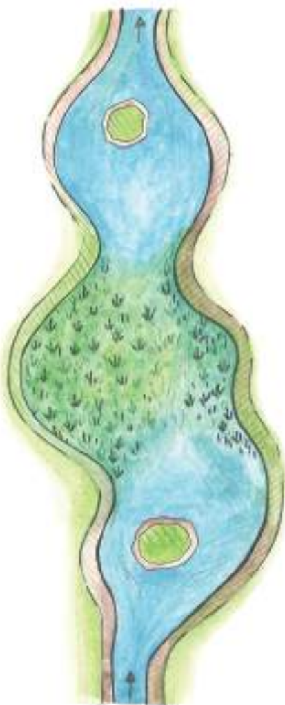
19. attēls. Virszemes plūsmas mitrāja virskata shematisks attēlojums (Autors: Alise Trifane).
